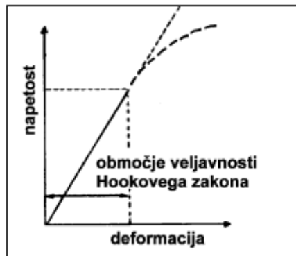
Slika 12: Odvisnost strižne napetosti od deformacije – Hookov zakon (20)
