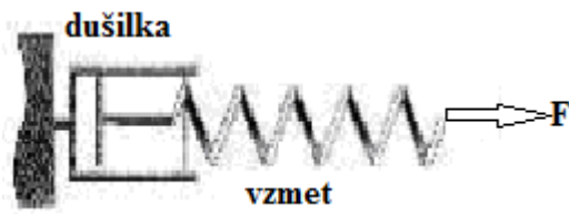
Slika 14: Maxwellov mehanski model (11)
