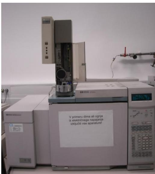
Slika 10: Plinski kromatograf z masno selektivnim detektorjem
