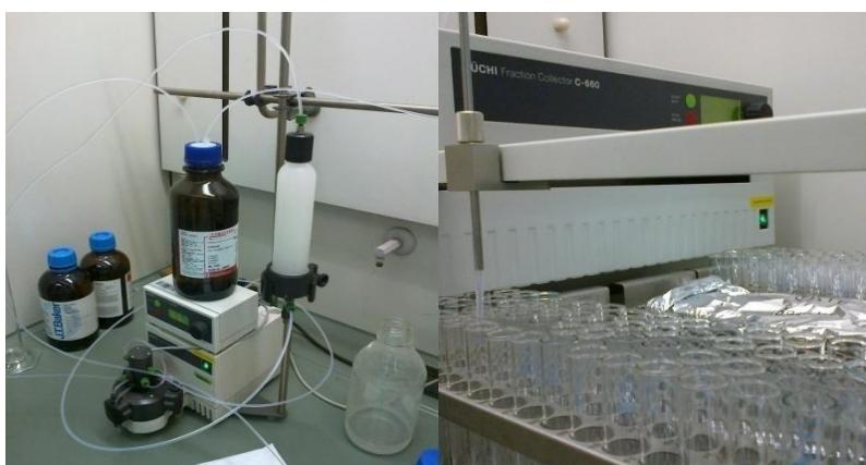
Slika 12: Aparatura za kolonsko »flash« kromatografijo.
