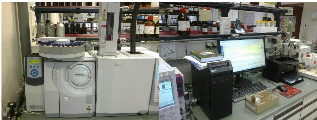
Slika 10: GC-MS aparatura.
