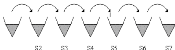
Slika 9: Shematski prikaz priprave standardov (S2-S7). (Povzeto po [58].)
