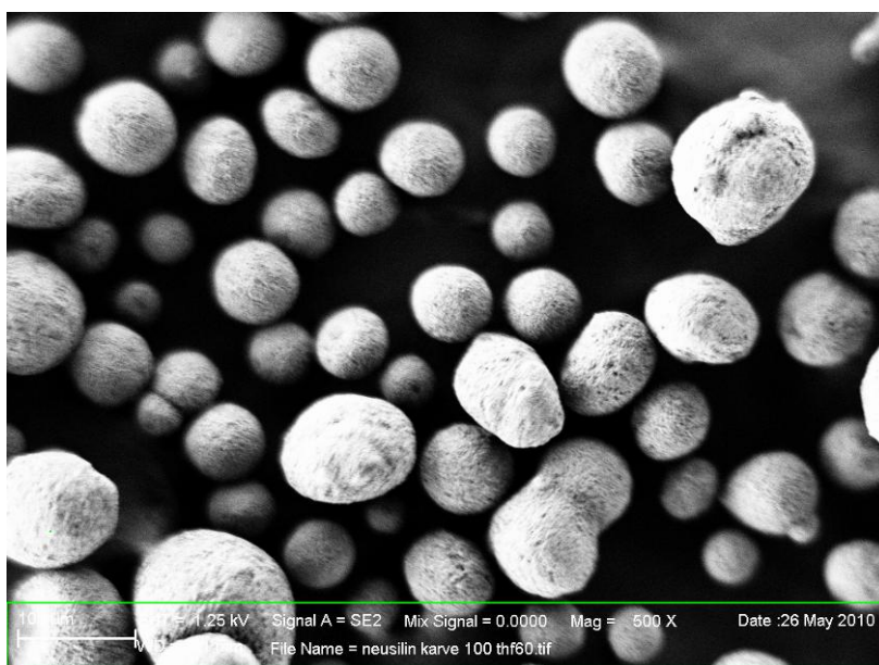
Slika 16: Elektronsko mikroskopska slika TD (učinkovina:Neusilin = 0,11:1 iz raztopine s THF) izdelane na stresalniku; povečava 500 X.
