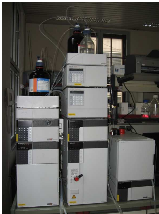
Slika 16: Na sliki je prikazan instrument Shimadzu LC-2010, ki se uporablja pri metodi HPLC.
