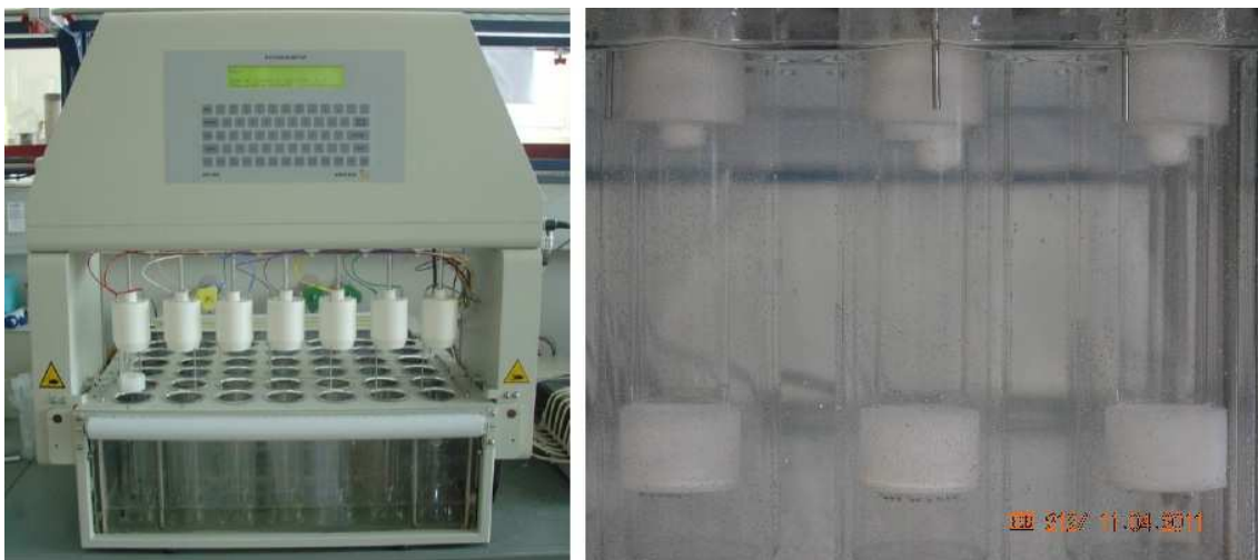
Slika 16: Naprava 3 po Ph. Eur. 7 th (levo) in plavajoče obložene tablete v cilindrih med testom sproščanja (desno).
