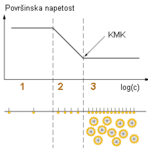
Slika 9: Tipičen graf odvisnosti površinske napetosti od logaritma koncentracije PAS.
