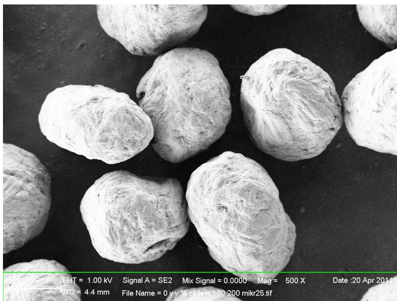
Slika 8a: Majhni delci zmesi I pod elektronskim vrstičnim mikroskopom pri 500-kratni povečavi
