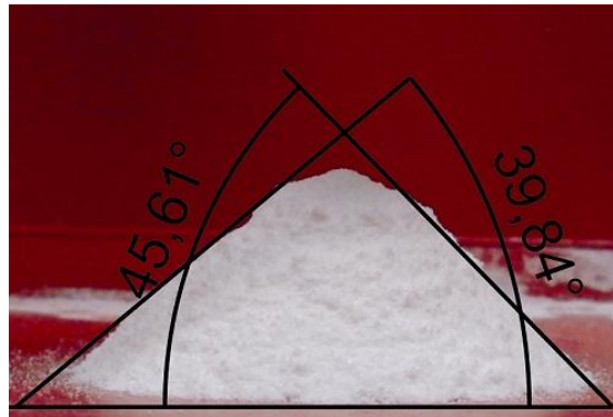
Slika 7: Prikaz določitve nasipnega kota
