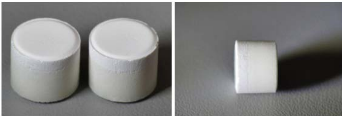
Slika 25 : Prikaz dvoplastne tablete v pokončnem (levo) in ležečem (desno) položaju.
