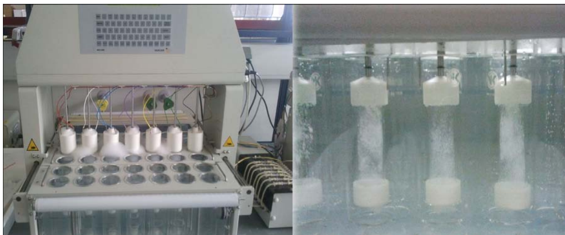
Slika 26: Naprava 3 po Ph. Eur. 7th (levo) in plavajoče obložene tablete v cilindrih med testom sproščanja (desno).
