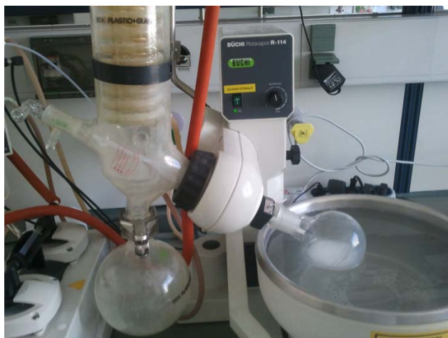
Slika 24: Aparat za odparevanje topila pri znižanem tlaku: BUCHI Rotavapor R-114, Švica.
