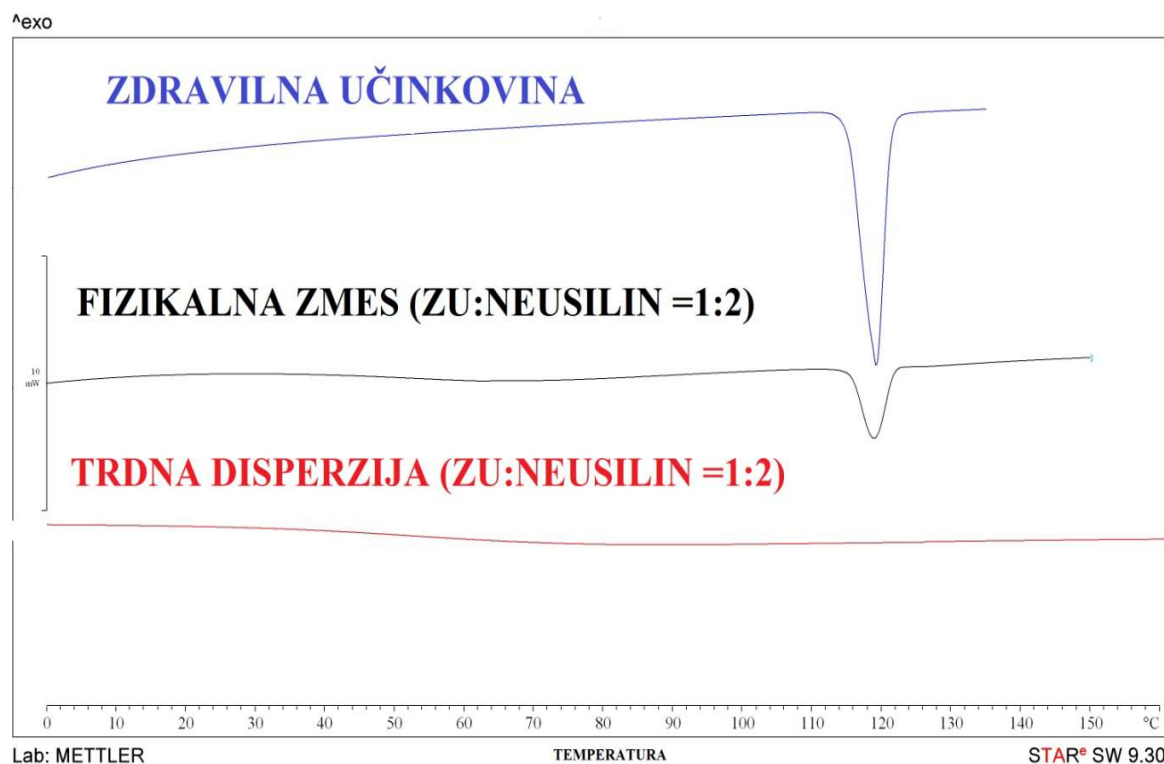
Slika 33: DSC krivulje kristalne oblike učinkovine, učinkovine v fizikalni zmesi in v TD. Pri slednjih dveh je razmerje med učinkovino in Neusilinom 1:2.
