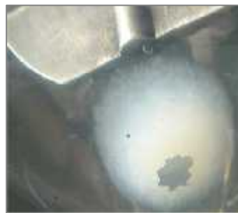
Slika 33: Prilepljena tableta - viden je suh del
