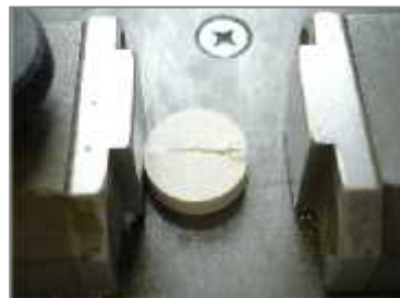
Slika 32: Tableta po preskusu trdnosti
