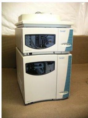
Slika 11: HPLC sistem Surveyor proizvajalca Thermo Finnigan (56)
