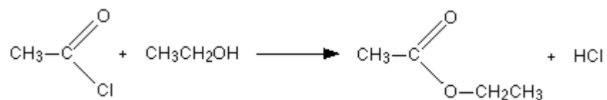
Slika 22: Reakcija med acetilkloridom in etanolom. [15]
