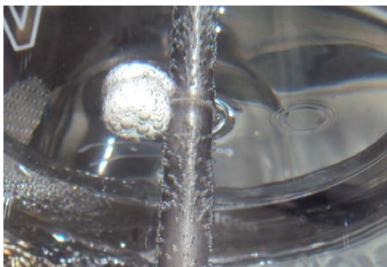
Slika 15: Mehurčki \text{CO}_2 , ujeti na površini tablete in v gelski mreži, so odgovorni za plavanje tablete.
