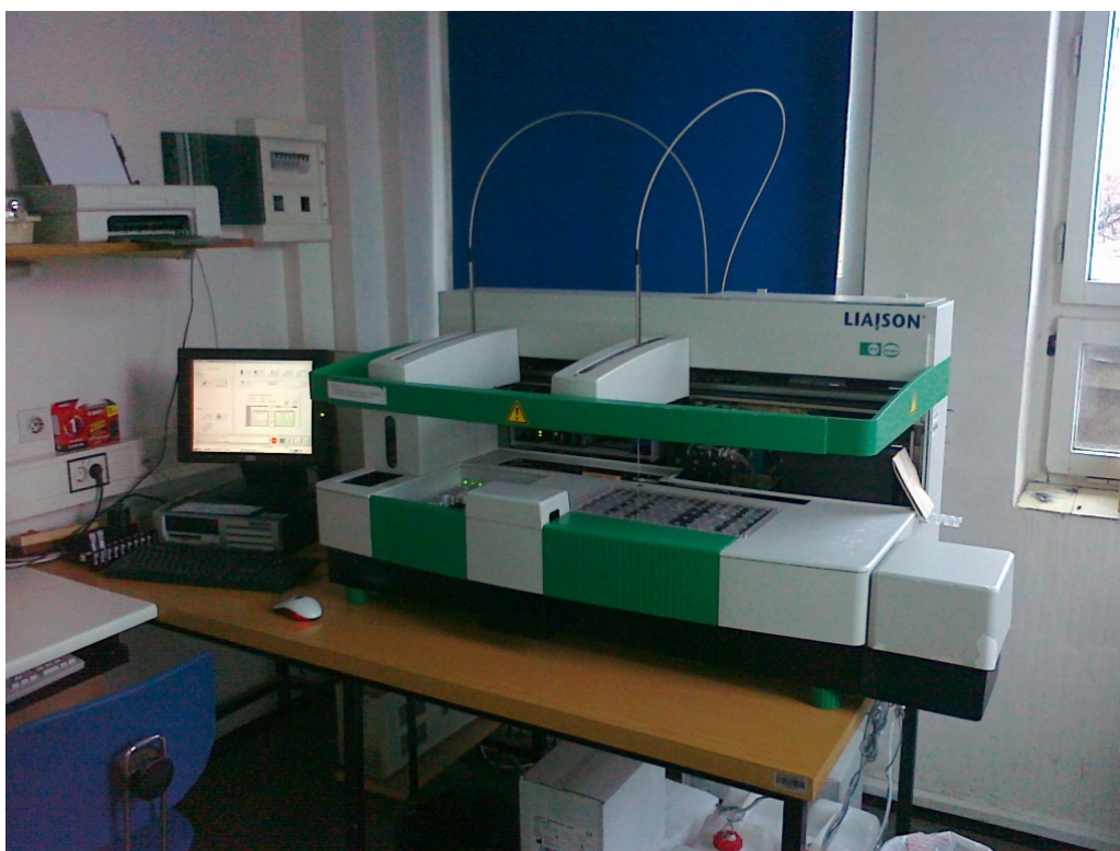
Slika 5: Analizator LIAISON®, na katerem smo določili koncentracijo CEA.
