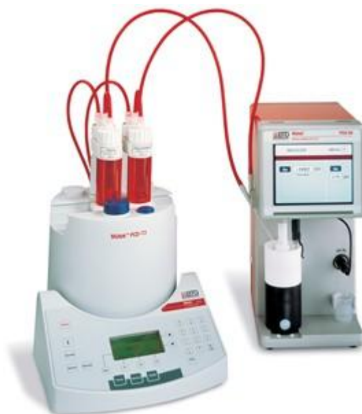
Slika 2: Aparatura za določitev gostote naboja PCD (11).
