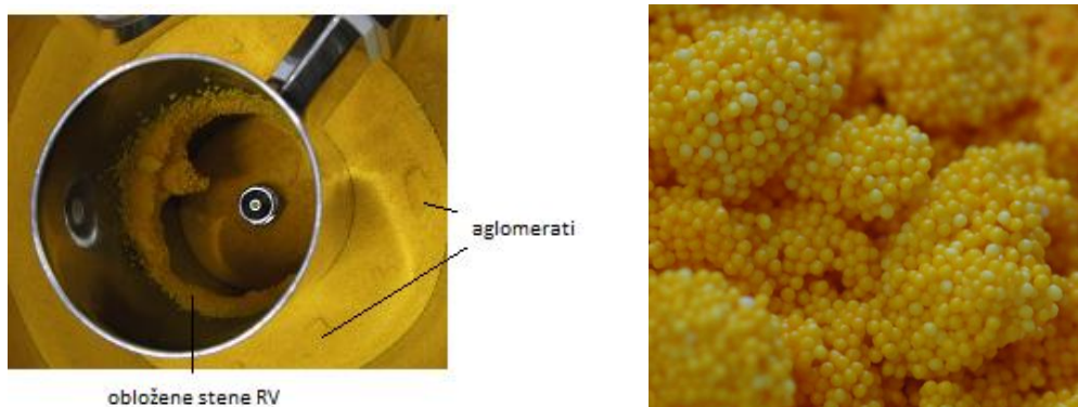
Slika 23 Notranjost razmejitvenega valja in aglomerati pri poskusu 2.
