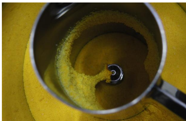
Slika 22 Obložena notranjost valja pri poskusu 1.
