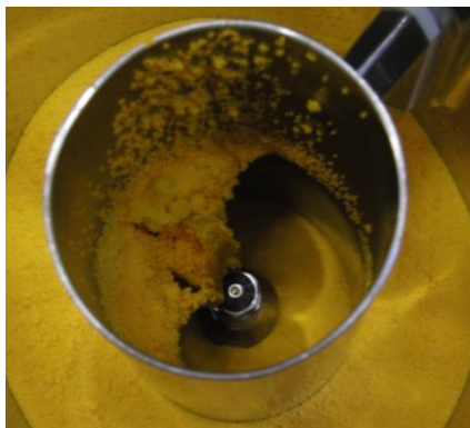
Slika 24 Notranost RV pri poskusu 3. Leva polovica valja je bila za krožeče delce popolnoma neprehodna.
