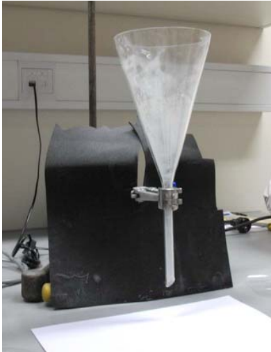
Slika 10: Steklen lij za merjenje pretočnega časa.
