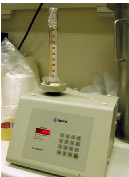
Slika 12: Mehanski stresalnik za določanje zbitega volumna.
