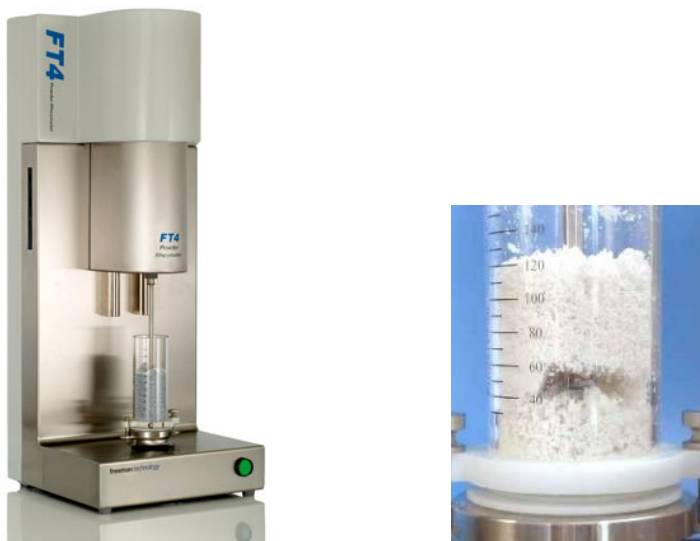
Slika 8: Levo: Praškovni reometer (FT4). Desno: Potovanje vijaka skozi stolpec prahu. (34)
