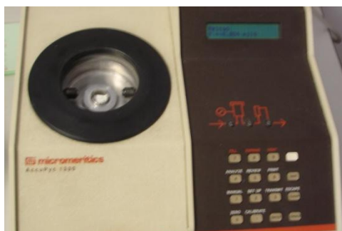
Slika 16: Mejenje gostote s Helijevim piknometrom.
