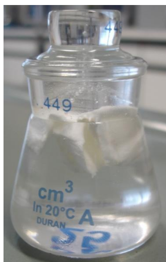
Slika 15: Mejenje gostote s Hubardovim piknometrom.
