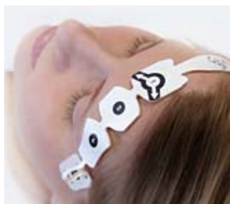
Slika 4. Elektrodni sistem za merjenje BIS-a
