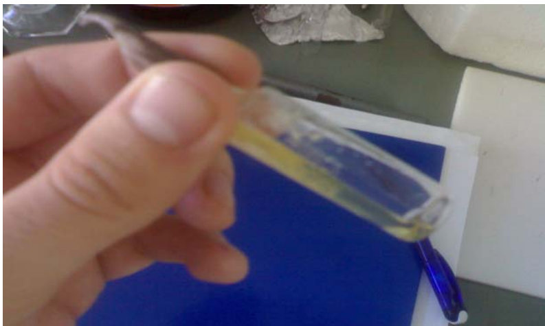
Priloga 1: Slika zataljene ampule po končani sintezi kopolimera.
