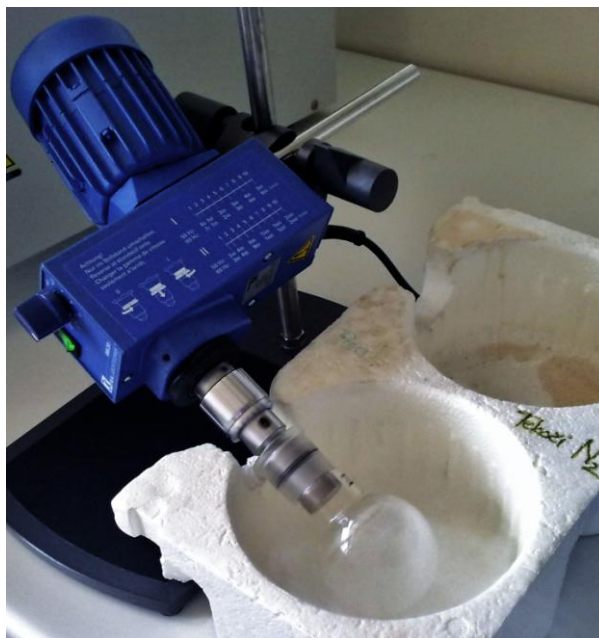
Slika 7: Zmrzovanje disperzije nanodelcev v vrteči se bučki s tekočim dušikom.
