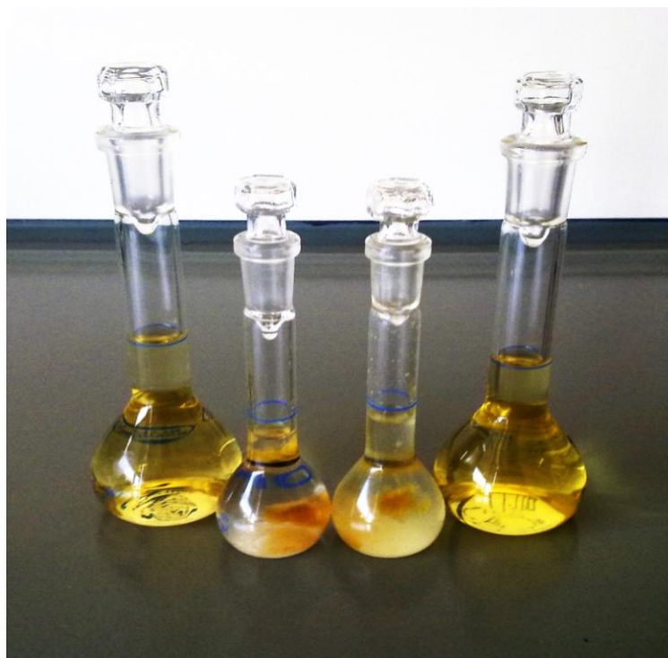
Slika 8: Disperzije Phospholipona® 50 (levi bučki) oz. Phospholipona® 80 (desni bučki) v etanolu (skrajni bučki) oz. acetonu (sredinski bučki).
