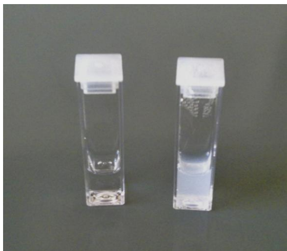
Slika 15: Raztopina ovalbumina pred (levo) in po (desno) izpostavitvi temperaturi denaturacije.
