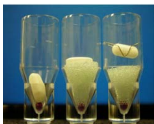
Slika 8: Različni položaji tablet v celici (12).
