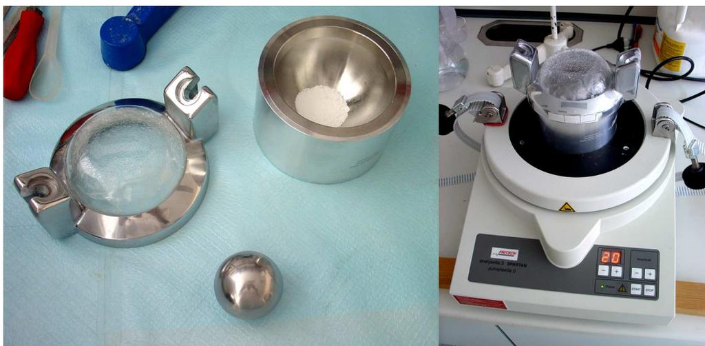
Slika 16. Vibracijski mlin Pulverisette 0 Fritsch.
