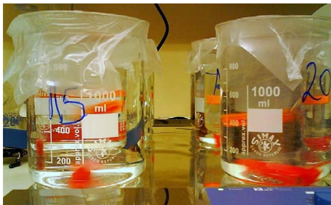
Slika 17: Dializna metoda: slika prikazuje čaše z raztopinami DM različnih koncentracij. Dializne vrečke v čašah so napolnjene z raztopino \lambda -karagenana s koncentracijo 0,33 g/L.
