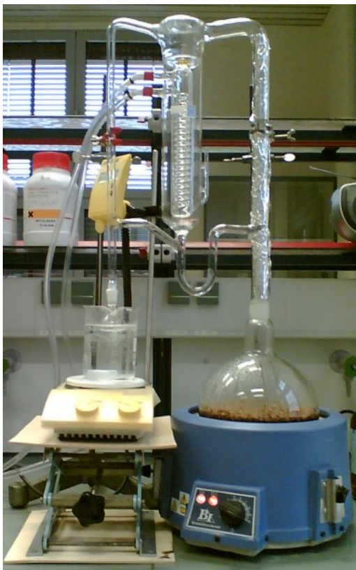
Slika 7: Sočasna destilacija z ekstrakcijo tatarske ajde v Likens-Nickersonovi aparaturi.
