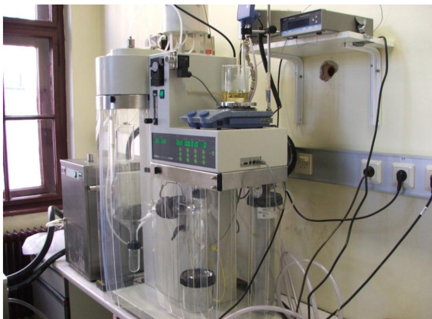
Slika 3: Sušilnik z razprševanjem Büchi B-296, ki je sicer v prvi vrsti namenjen razprševanju s sušenjem, a je z njegovo modifikacijo mogoče izvajati tudi proces razprševanja s strjevanjem.
