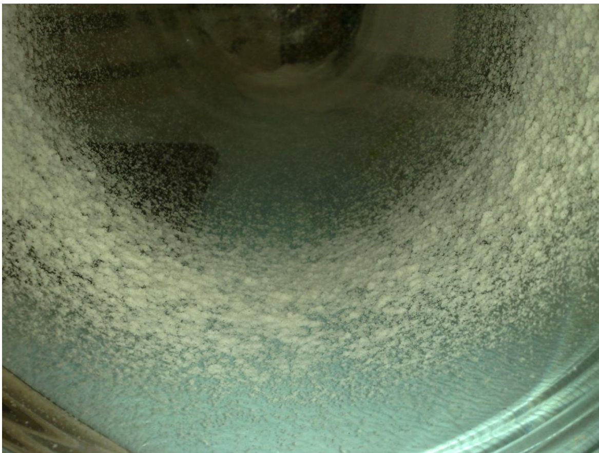
Slika 13: Slika trde skorje v zgornjem delu komore zaradi uporabe previsoke hitrosti dovajanja taline.
