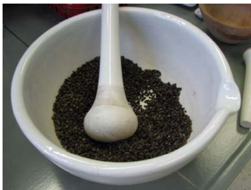
Slika 11: Mehanska obdelava ajdovih zrn s trenjem v terilnici
