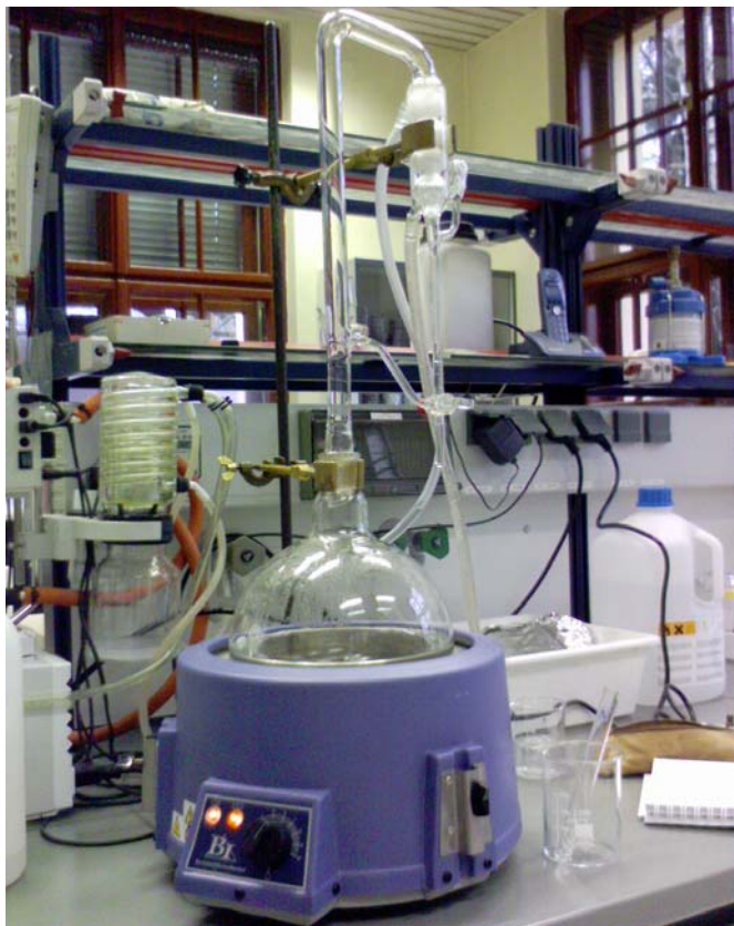
Slika 8: Clevengerjeva aparaturo, ki smo jo uporabili v poizkusih
