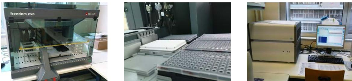
**Slika 17:** Avtomatski pipetor EVO®75 in ciklični pomnoževalnik LightCycler® 480
