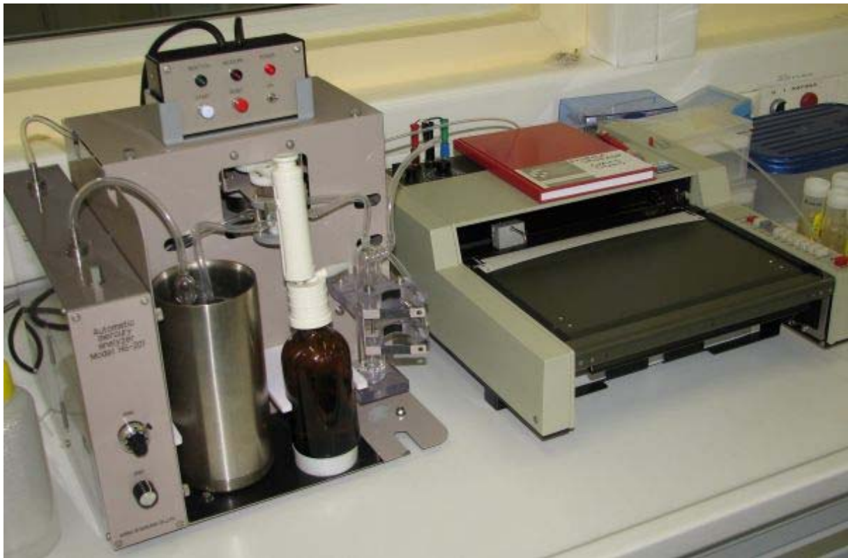
Slika 4: Aparatura za atomsko absorpcijsko spektrometrijo hladnih par z redukcijsko celico, steklenico z raztopino \text{SnCl}_2 , kondenzacijsko pastjo in zapisovalnikom
