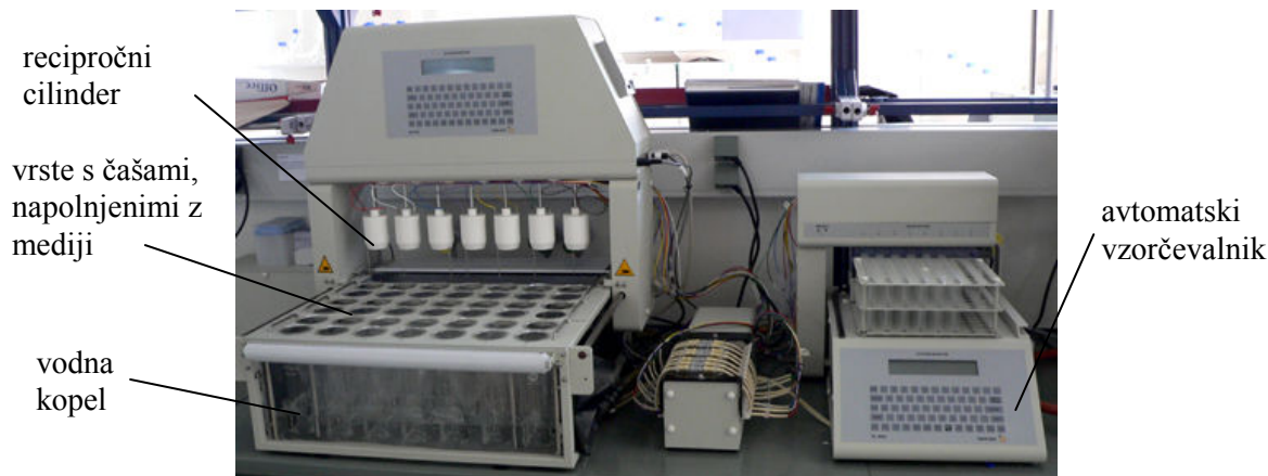
Slika 11: Sestavni deli naprave z recipročnimi cilindri BIODIS (Naprava 3, Ph.Eur. 6.0).
