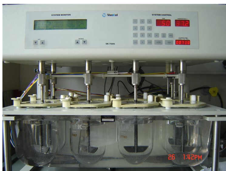
Slika 16: Naprava za sproščanje 2 po USP. Na kontrolni plošči je vidno število vrtljajev vesla (rpm=50) in temperatura vodne kopeli (37,2°C).
