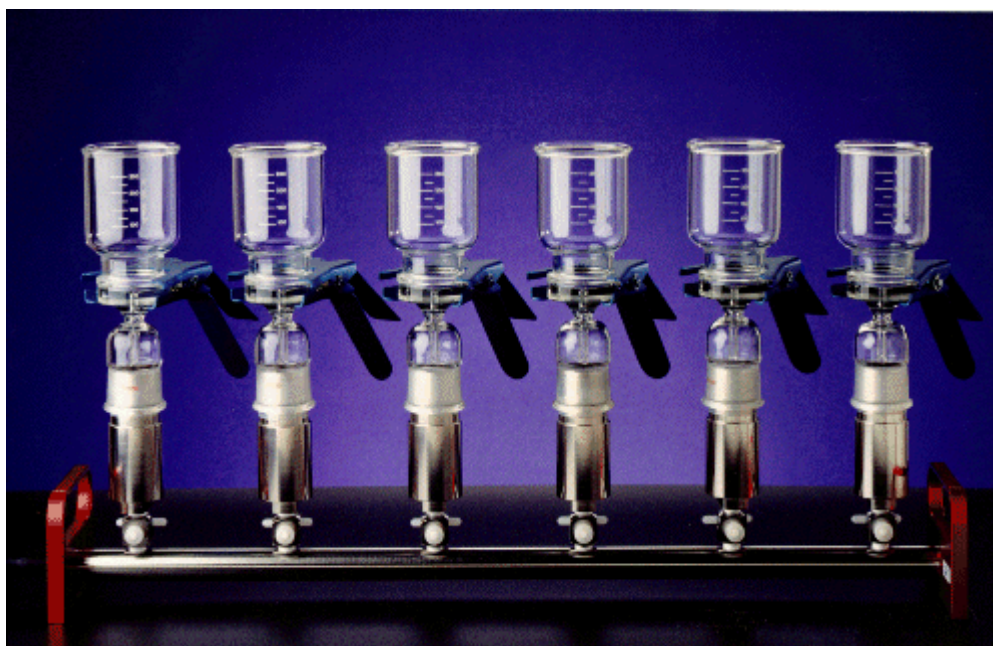
Slika 12: Sistem za SPE na ekstrakcijskih diskih
