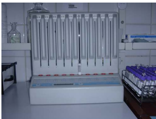
Slika 13: Aparatura za odčitek meje med eritrociti in plazmo pri preiskavi HSE.
