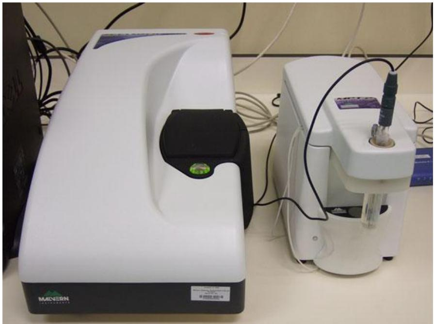
**Fotonska korelacijska spektroskopija je metoda določanja velikosti delcev v nanometerskem območju (0.6 nm – 6  $\mu\text{m}$ ).**
