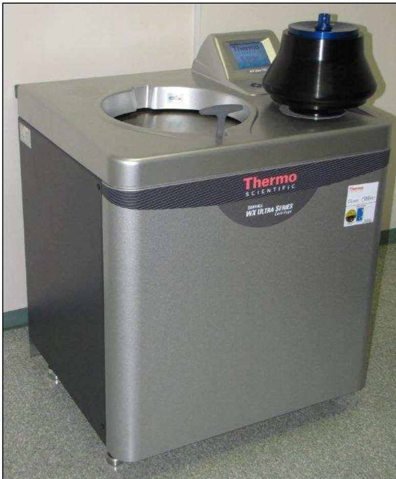
**Ultracentrifuga omogoča centrifugiranje s hitrostjo do 100.000 obratov/min (pospešek do 800.000 x g). Takšne sile so potrebne za ločevanje koloidnih delcev od disperznega medija. Ultracentrifuga je opremljena s štirimi rotorji, ki omogočajo centrifugiranje vzorcev z volumni od 1,5 ml do 250 ml.**
