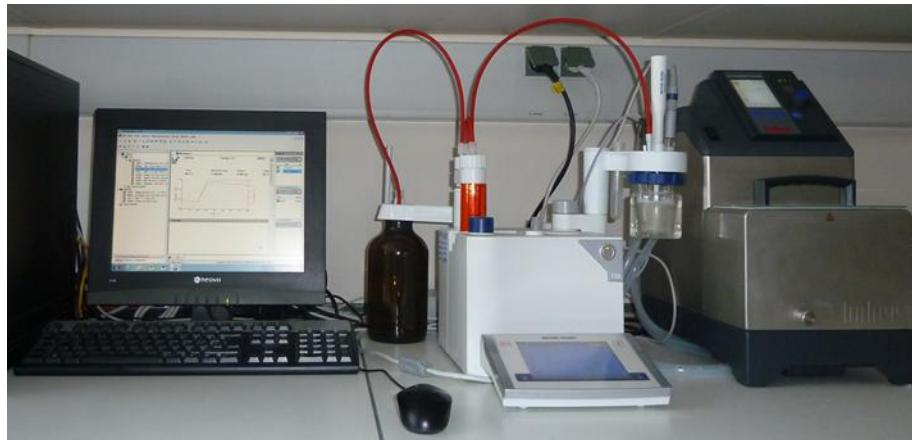
Titrator omogoča varno, prilagodljivo in učinkovito izvajanje titracij ob simultanem mešanju. Aparatura nam nudi tudi izvajanje titracij ob vzdrževanju pH (pH-Stat titracije) ter s stalnim nadzorom temperature.
