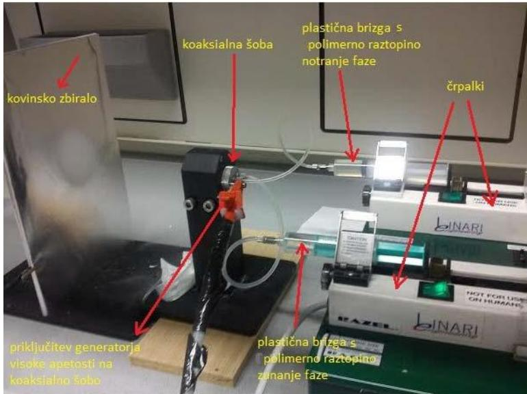
**Naprava za elektrostatsko sukanje omogoča izdelavo eno- ali dvoslojnih nanovlaken iz številnih raztopin sintenznih ali naravnih polimerov.**
