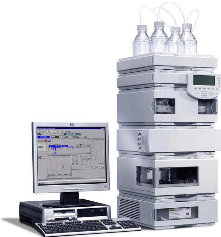
Aparatura omogoča kromatografsko detekcijo in kvantifikacijo analitov, učinkovin, njihovih razgradnih produktov ter metabolitov.
