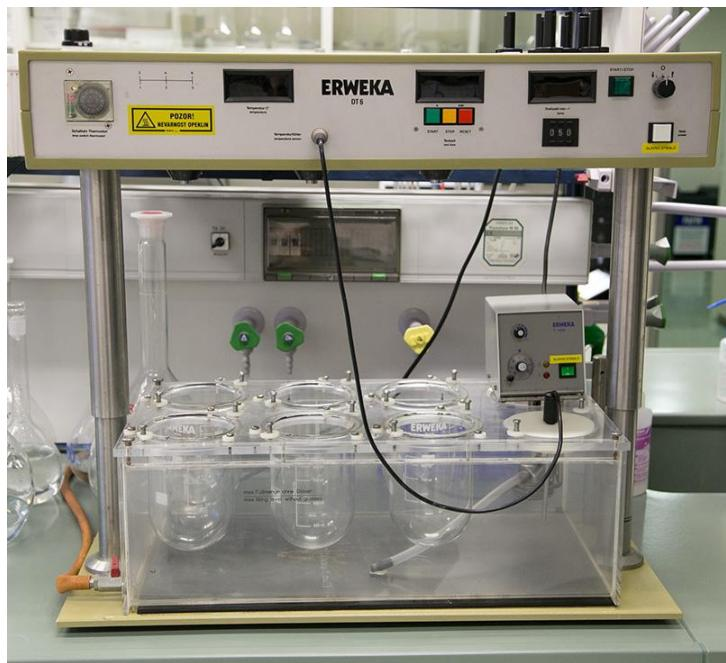
Test raztpljanja z Erweko DT6 se lahko uporablja kot naprava s košaricami (Naprava 1) ali naprava z vesli (Naprava 2).
