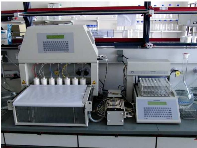
BioDis je oprema, ki omogoča spremljanje sproščanja zdravilnih učinkovin iz peroralnih farmacevtskih oblik s pritejenim sproščanjem: zaksanelim, podaljšanim ali pulzirajočim. Opremljen je za avtomatskim vzorčevalnikom
