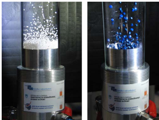
Prototip mikrooblagalnika: oblaganje pelet (levo) in mini tablet (desno)
