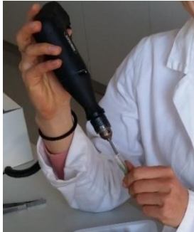
Slika 20: Mletje vzorcev z električnim brusilnikom Bruder Mannesmann
