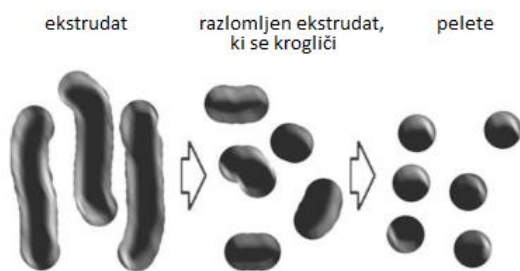
Slika 2: Faze nastanka pelet iz ekstrudata (6)
