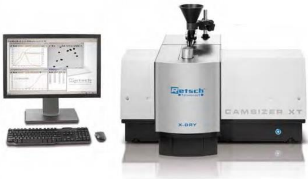
Slika 11: Naprava Camsizer XT, ki omogoča optično analizo velikosti in oblike delcev (25)
