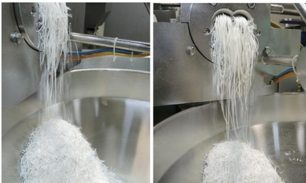
Slika 10: Fotografija nastajajočega ekstrudata v proizvodnji
