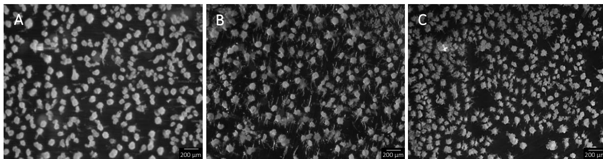
Slika 15: Mikrodcelci laktoze, izdelani pri 35 °C, 25 % RH iz A – 19-odstotne raztopine ( \Delta h : 4 mm, IC: 10 cm, Q notranje igle: 3 mL/h, Q zunanje igle: 3 mL/h, \Delta U 10,1 kV), B – 25-odstotne raztopine ( \Delta h : 8 mm, IC: 15 cm, Q notranje igle: 5 mL/h, Q zunanje igle: 5 mL/h, \Delta U : 16,5 kV), C – 37-odstotne raztopine ( \Delta h : 8 mm, IC: 15 cm, Q notranje igle: 2 mL/h, Q zunanje igle: 2 mL/h, \Delta U : 10,5 kV).
