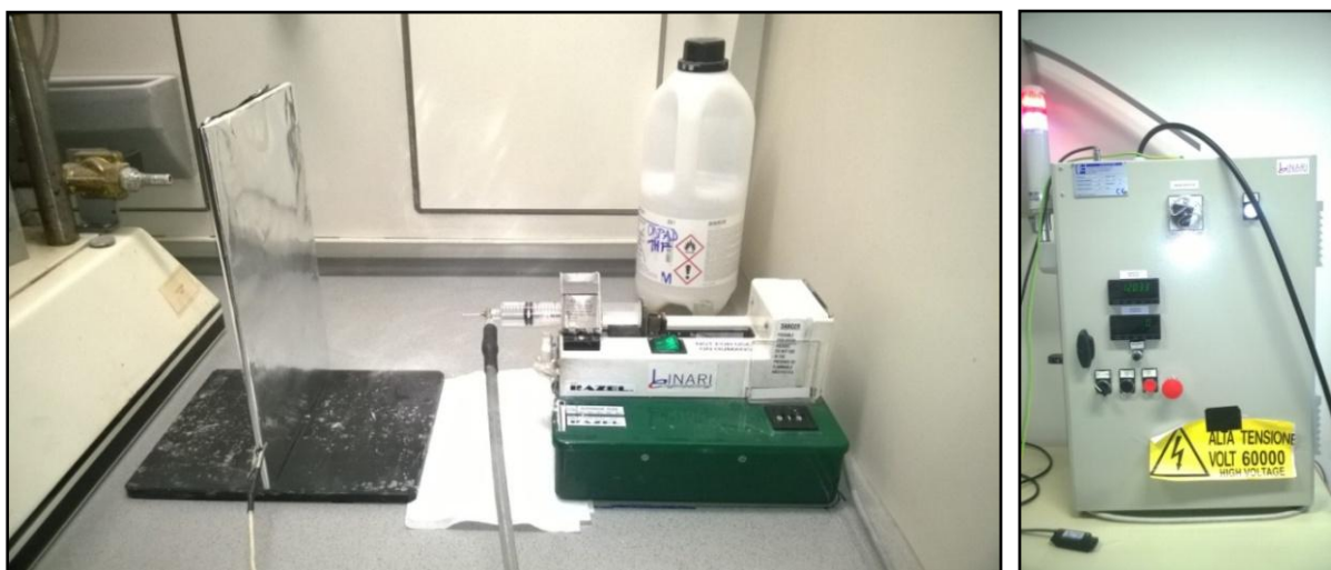
Slika 8: Naprava za elektrostatsko sukanje; na levi strani imamo mehansko črpalko z brizgo ter kovinsko zbiralo, na desni strani pa generator visoke napetosti.
