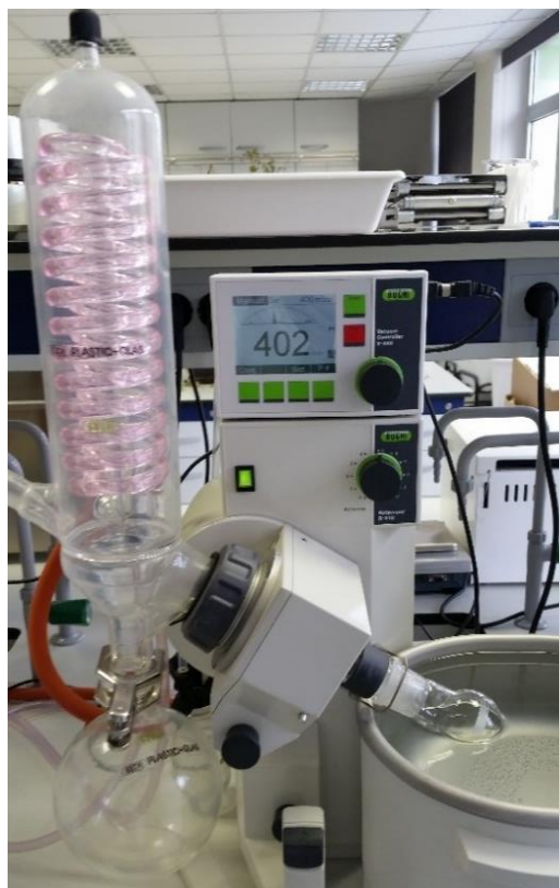
Slika 13: Bučka s končnim produktom na rotavaporju, slikano 8. 12. 2015. Foto: Marko Potočnik
