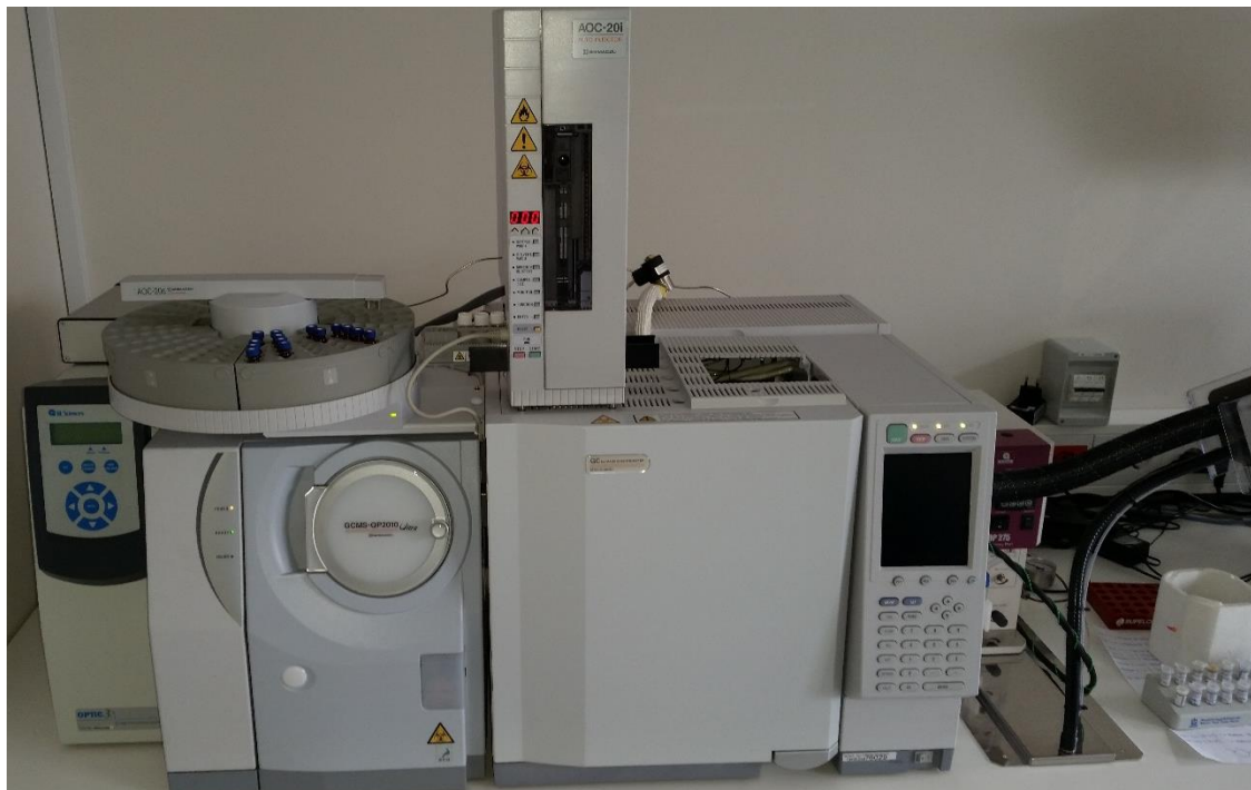
Slika 12: Aparatura GC-MS, slikano 9. 3. 2016. Foto: Marko Potočnik
