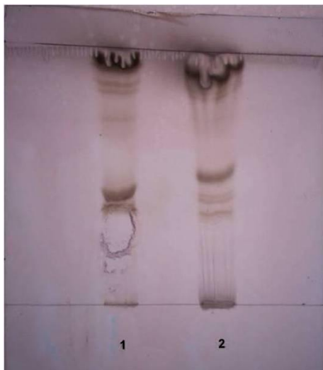
Slika 8: TLC ploščica po nanosu 22 \mu\text{L} vzorca izolacije 1 (levo) in 22 \mu\text{L} vzorca izolacije 2 (desno) po barvanju z mešanico 10% bakrovega sulfata in 8% fosforne kisline
