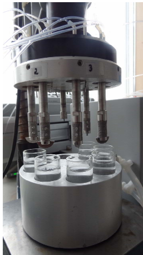
Slika 12: Vesla s posodami in ogrevalnim blokom
