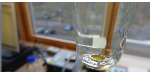
Slika 14: Držalo za DSC vzorec s samim vzorci v posodi za sproščanje
