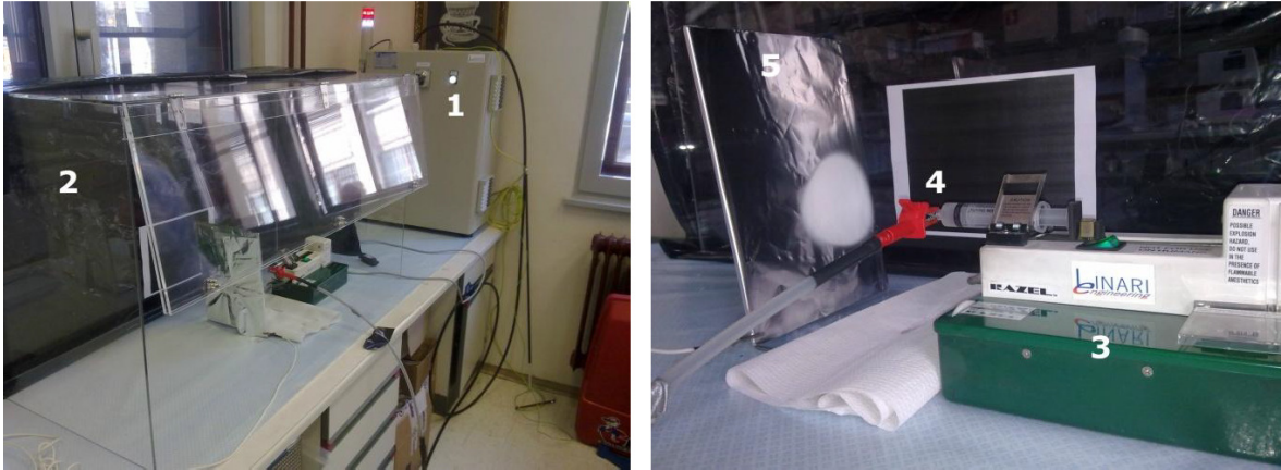
Slika 11: Aparatura za elektrostatsko sukanje. 1 – generator visoke električne napetosti, 2 – plastična komora, 3 – črpalka, 4 – kovinska igla, 5 – zbiralo (povzeto po (29)).
